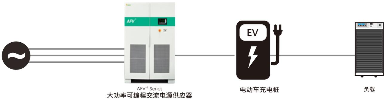
充电桩在正式投入使用之前，需要对交流输入特性、控制导引讯号输出特性、时序以及 瞬时特性、保护功能等进行测试。AFV<sup>+</sup> 系列大功率可编程交流电源供应器可以为待测充电桩提供高质量、稳定的测试电源。
