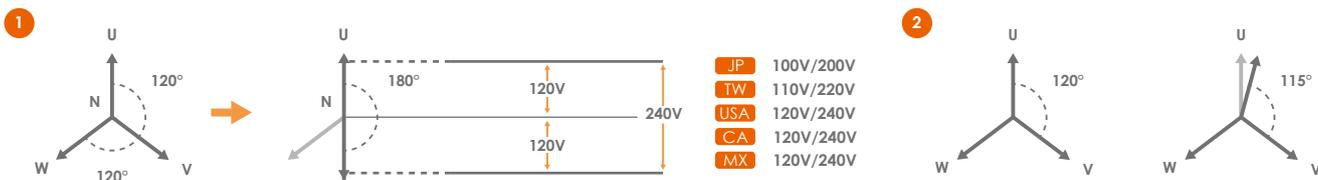
AFV+ 系列能够独立设置每个相位的电压，并透过选配的相位角可调功能模拟各种电源条件。一台设备即可轻松模拟单相三线或单相两线电源系统，满足多样化测试需求。
