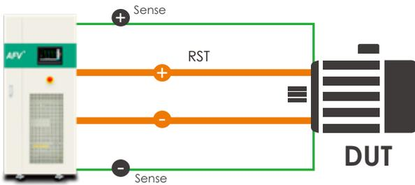
在许多任务厂或实验室，电源与负载在配置上会有一些的距离，AFV<sup>+</sup> 系列的远端补偿功能可防止距离所产生的压降，让使用者免去调整电压的不便。
