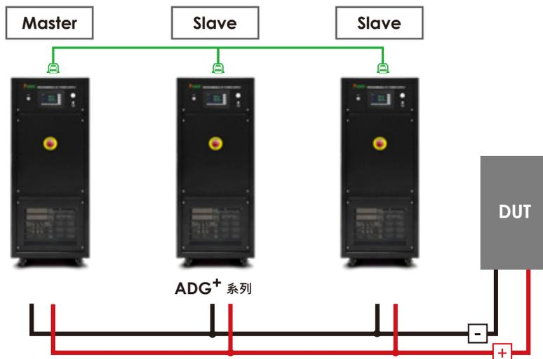
ADG+ 系列单机功率最高可达 300kW，并可透过简易的主从并机设置 (Max. 6 台) 加大输出功率至 1800kW，用户仅需在主机上操作和设置，从机即可接收数据并达到均流之效果，为市场上少数单机大功率且具有并机功能的直流电源，用户可依需求以单机或并机使用，应用上更具弹性。
